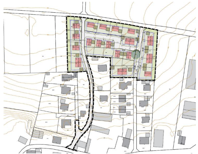
Variante 2 vom 12.05.2025, IB Eichenseher, nun mit erweitertem Geltungsbereich mit 1,4 ha, hier mit Erhalt der Stiel-Eiche und mit 4-5 m breiter Ortsrandeingrünung
