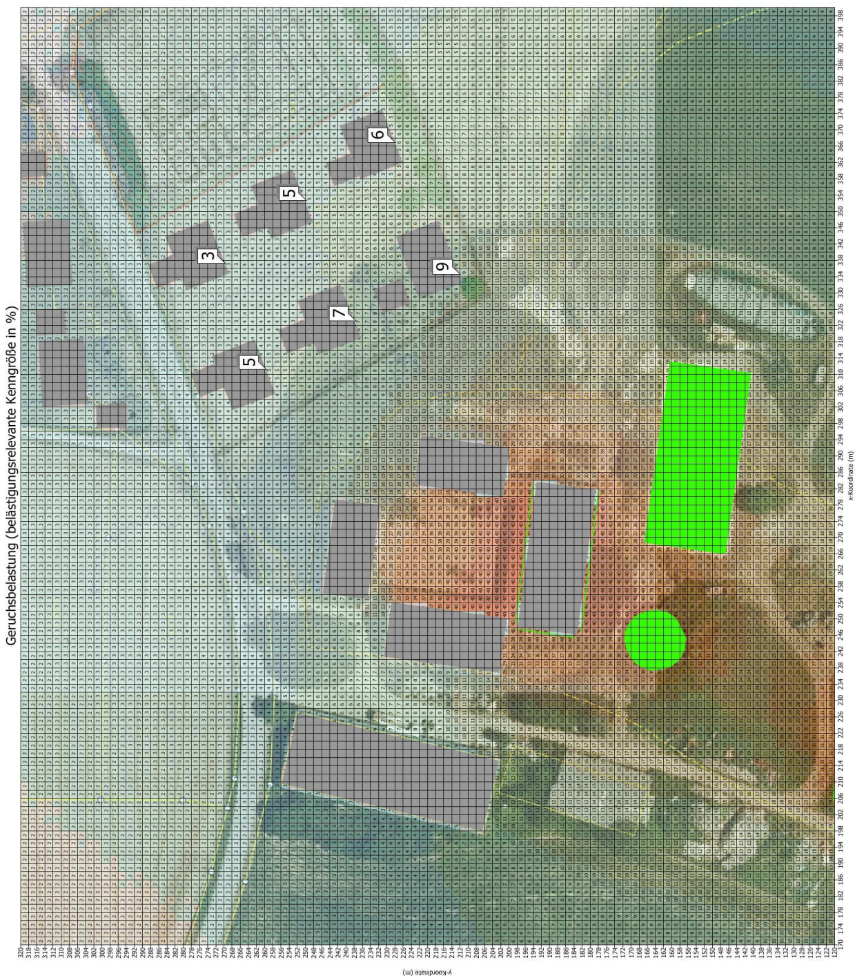
Abbildung 10: Berechnete Geruchsbelastung (belastigungsrelevante Kenngröße) an dem geplanten Baugebiet durch den geplanten geänderten Betrieb
