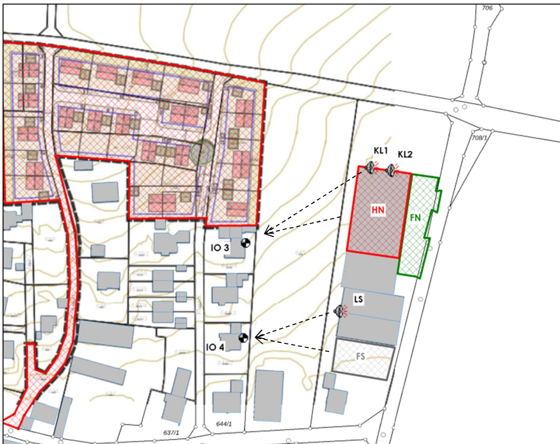
Abbildung 9: Lageplan mit Darstellung der Schallquellen und der emissionsbeschränkenden Wohnnutzungen
