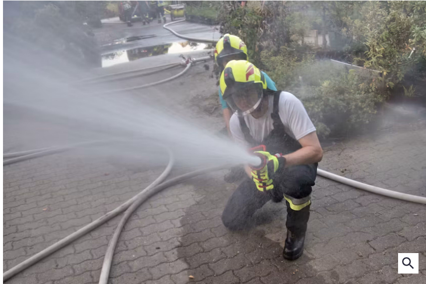
D-Schläuche sind dünn und leicht – und daher in dynamischen Lagen von Vorteil. Peter Hinz-Rosin
