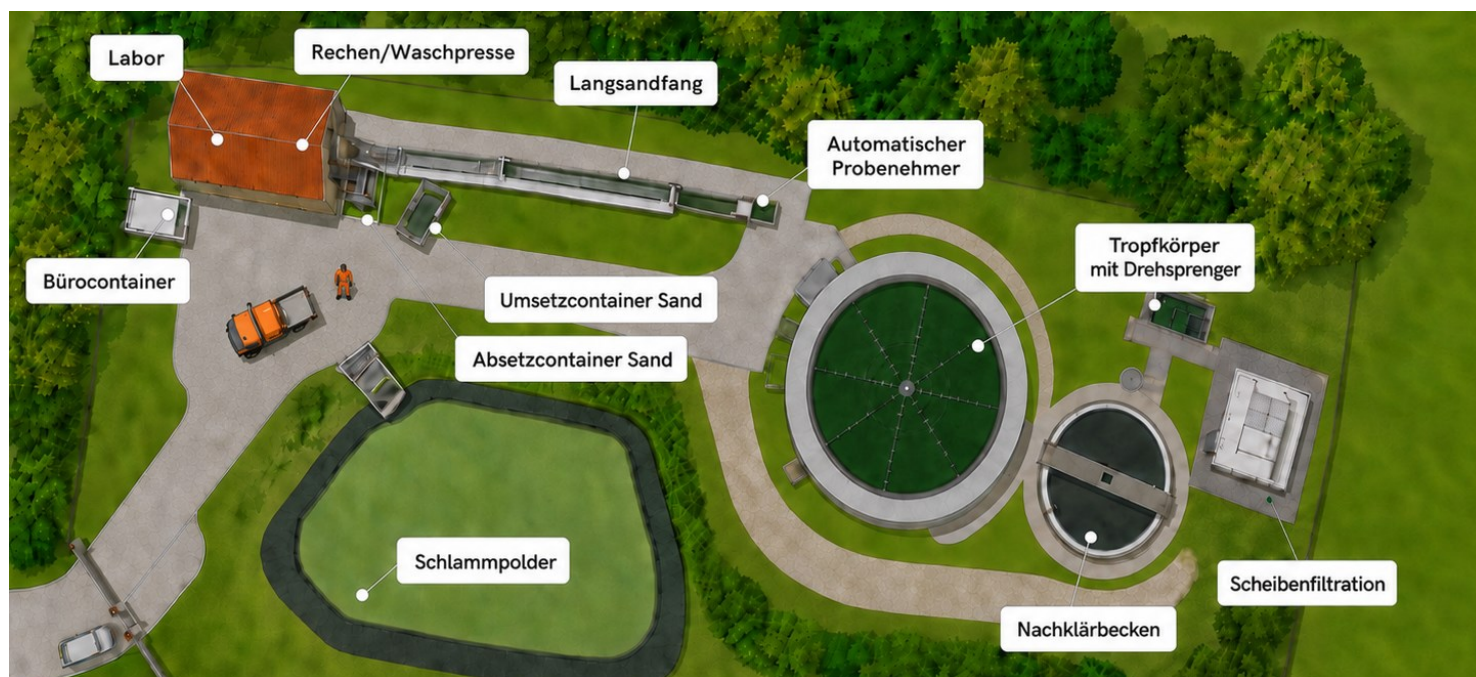
Bild: Kläranlage derzeitiger Bestand
